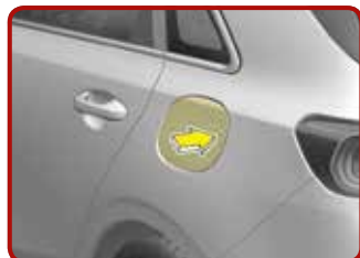
Apertura dello sportello di rifornimento carburante [4]
