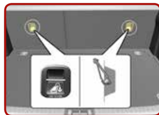
Fissaggio con sistema di "ancoraggio flessibile" [3]
